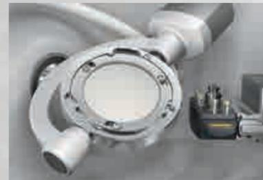
inLab MC X5 verarbeitet Standardronden (Ø 98,5 mm, Stärke bis zu 30 mm) sowie Blöcke in nur einer Maschine. In Kombination mit freier Materialauswahl bietet sie Ihnen heute und in Zukunft ein breites Indikationsspektrum. Der Wechsel zwischen Rondens und Blöcken erfolgt innerhalb weniger Sekunden. Der innovative Multiblockhalter nimmt bis zu sechs Blöcke unterschiedlicher Materialien auf und sorgt so auch bei mehreren Einzelzahnarbeiten für ein Höchstmaß an Produktivität.
