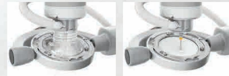
Je nach Material und Indikation fertigt inLab MC X5 trocken, nass oder in Trocken-Nass-Kombination während eines Bearbeitungsvorgangs. 30 Jahre Sirona-Erfahrung in der Nassbearbeitung von Glaskeramiken machen die Maschine zum absoluten Profi im Nass-Schleifen von vollanatomischen Restaurationen aus endfesten monolithischen Materialien. Der Wechsel zwischen Nass- und Trockenfertigung, wie z. B. von Glaskeramik auf Zirkonoxid, erfolgt schnell und direkt.
